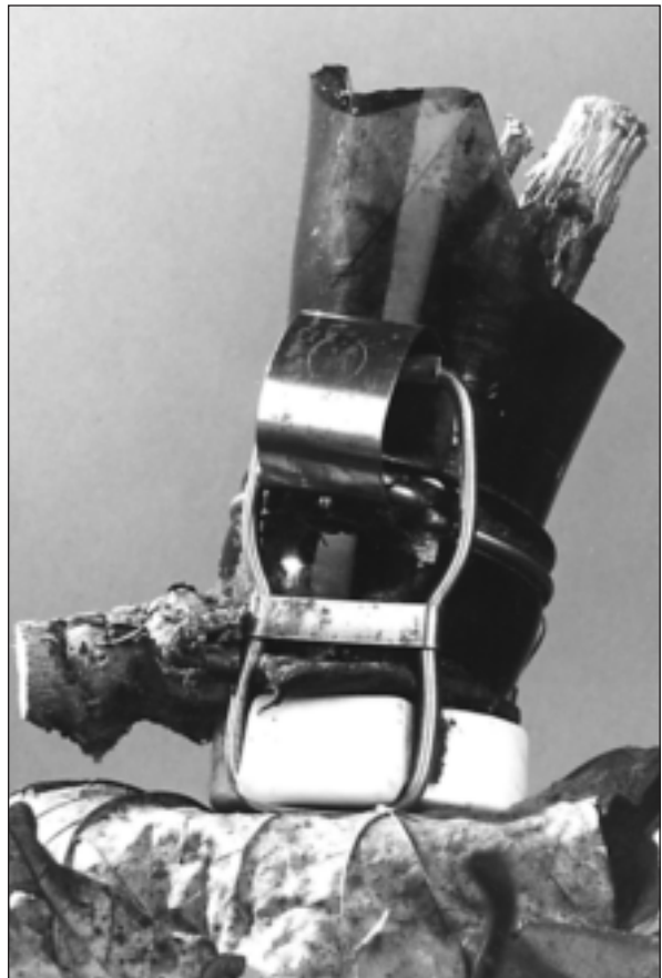
Abb. 20: Eine Wurzel wächst in den abgebrochenen Hals einer Bierflasche, perforiert Gummidichtung und Schnappverschluss und spreizt den Verschluss.
